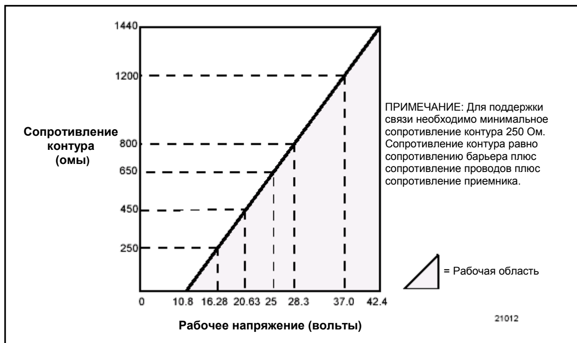
Рис. 2—График зависимости сопротивления контура от напряжения питания
